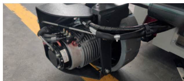
Motores eléctricos de tracción en corriente alterna en las ruedas delanteras.
