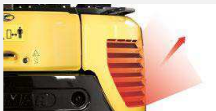
Evacuación del aire de refrigeración del motor orientada hacia arriba (protección de las personas y plantas en el entorno)
